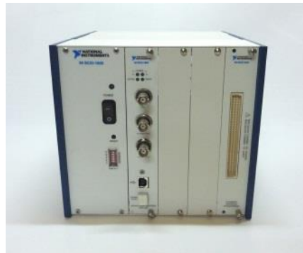
Acondicionador y adquisidor de señales
